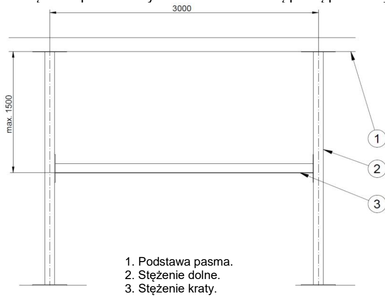
Rys. 16 Montaż stężeń podstawy i kraty.
